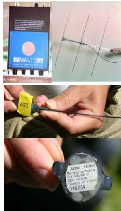
Figura 1: Arriba: receptor y antena de tres elementos; abajo: transmisor utilizado para lechuzas blancas. Fotografías: A. Muñoz-Pedrerros.
